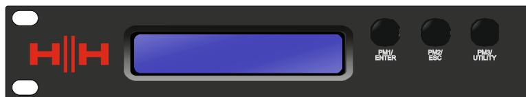
Le HH SP48 est équipé de 3 encodeurs relatifs, PM1/ENTER, PM2/ESC et PM3/UTILITY. Ces encodeurs vous permettent de naviguer dans l'interface utilisateur et de modifier les sections du processeur. L'encodeur rotatif PM1/ENTER est utilisé pour naviguer dans les menus et les sous-menus ainsi que pour confirmer les modifications. Les encodeurs PM2/ESC et PM3/UTILITY permettent de modifier les paramètres sélectionnés ainsi que de quitter/annuler les réglages et d'entrer dans le menu utilitaire.
