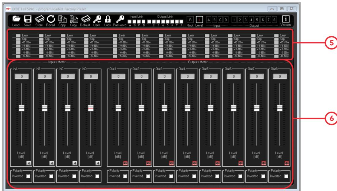
5. Niveaux de mesure pour chaque entrée et sortie. Affiche les niveaux dB du canal ainsi que si le limiteur est actif.
